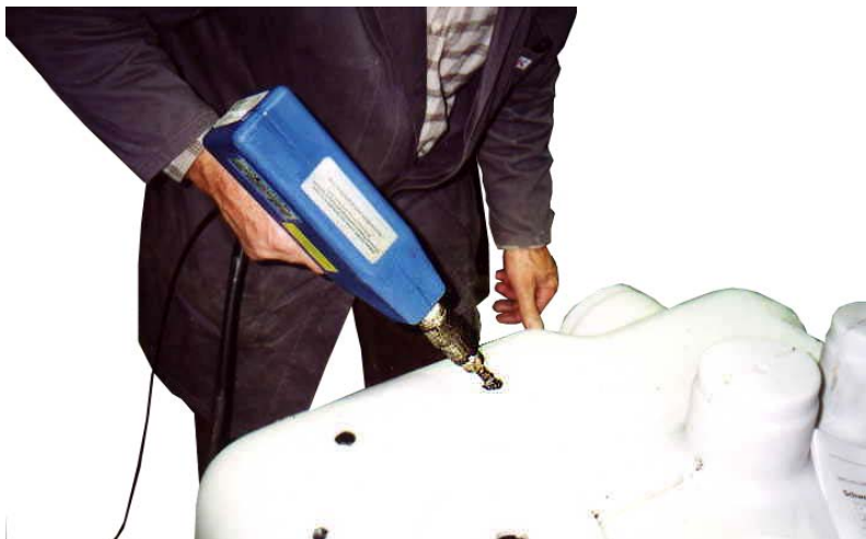
Bild1a: Reparatur von rotierten Teilen mit dem Drader Injectiweld (für das Bild mit schwarzem Schweißdraht geschweißt).
