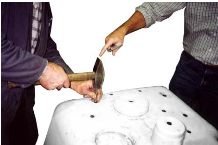
Bild 2: Prüfen von Schweißstellen mit zugeschweißten Löchern.
