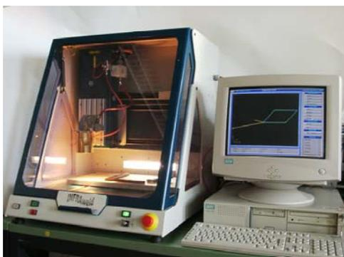
IR-Schweißstation als halbautomatischer Handarbeitsplatz zum Kunststoff-Durchlichtschweißen.
