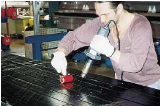
Karbonbeschichtung einer Landeklappe für den Airbus A320
